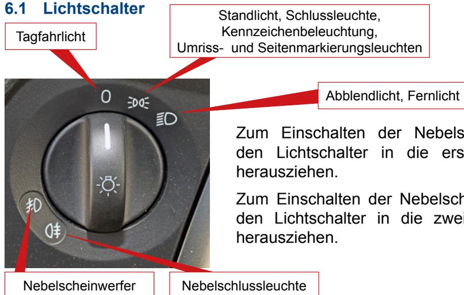
Zum Einschalten der Nebelscheinwerfer den Lichtschalter in die erste Position herausziehen.
