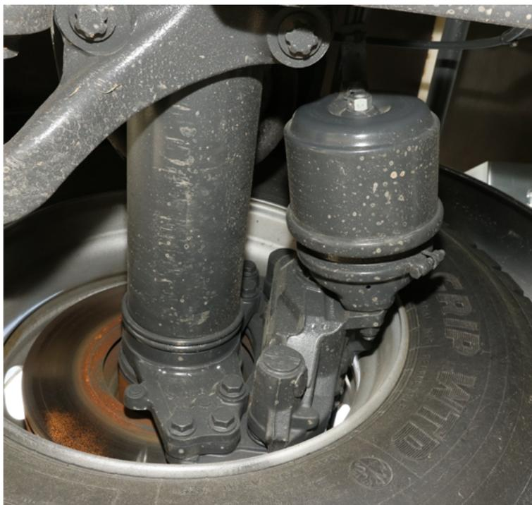
**Kombibremszylinder und Scheibenbremsen an der HA** mit Drehzahl Sensor in der Radnabe und Verschleißanzeige sowie Temperatur-Überwachung der Scheibenbremsen
