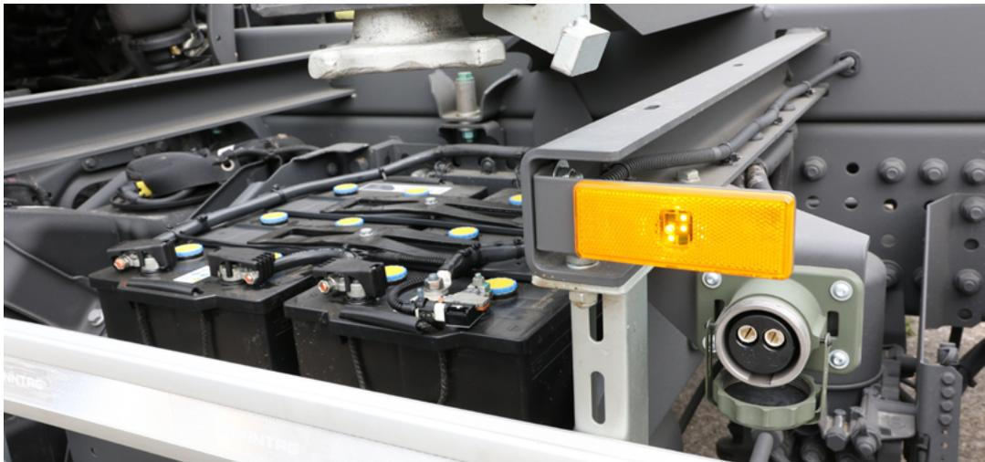
Nach Fremdstart 5 min verbunden lassen. Einige Verbraucher einschalten (Induktionsspannung vermeiden).
