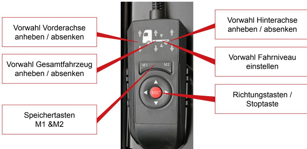
Sie können die Niveauregelung bei Fahrzeugstillstand oder während der Fahrt bis etwa 30 km/h bedienen:
