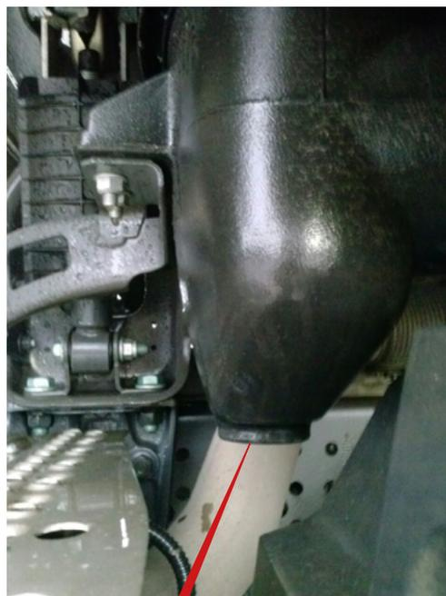
Grobstaubauswurfventil unterhalb Ansaugschachts
