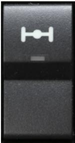
Durch Betätigen der Taste wird die Ausgleichsgetriebeesperre aktiviert. Durch erneutes Betätigen wird sie deaktiviert. Die geschaltete Sperre wird durch eine rote Kontrollleuchte im Schalter sowie im Achs-Menü des Displays angezeigt.
