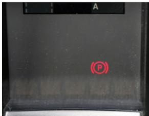
Die Kontrollleuchte im Kombiinstrument leuchtet.
