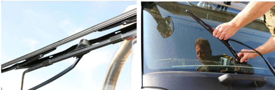
Sicherheitshinweis: Grundsätzlich erfolgt die Überprüfung der Scheibenwischerblätter im Fahrerhaus. Einmal wöchentlich hat diese Überprüfung außerhalb des Fahrzeugs zu erfolgen. Hierzu ist aus Arbeitsschutzgründen eine z. B. „Aluminium-Podestleiter einseitig begehbar“ oder ähnliches zu verwenden.
