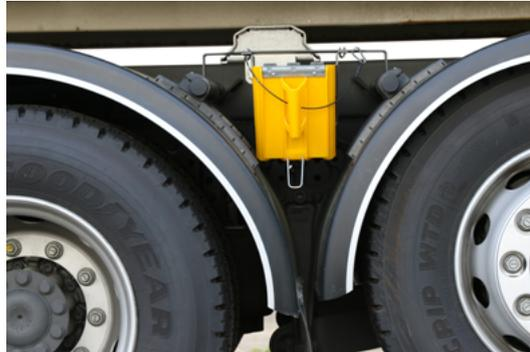
Unterlegkeile dienen dazu, das Fahrzeug zusätzlich zur Feststellbremse gegen Wegrollen zu sichern. Sie müssen leicht zugänglich und sicher zu handhaben sein.
