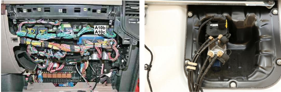
Das Steuergerät Elektronische Bremssteuerung (A10b Wabco bzw. A10c Knorr) ist im Elektronikfach auf der Beifahrerseite eingebaut. Der Bremswertgeber (linke Fzg-Seite hinter der Wartungsklappe) in Verlängerung des Bremspedals.
