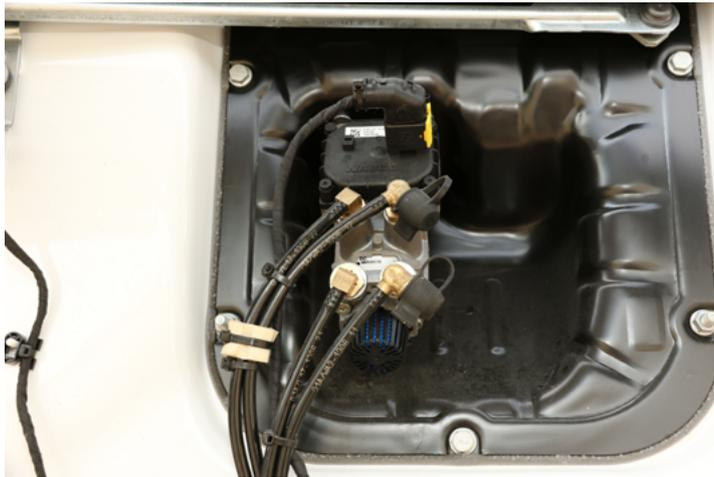
**Bremswertgeber:** Steuert den Bremsdruck für die Bremsanlage:
