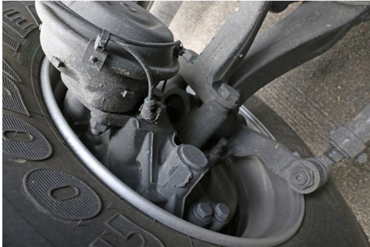
Membranbremszylinder und Scheibenbremse an der VA mit Drehzahlsensor in der Radnabe und Verschleißanzeige sowie Temperatur-Überwachung der Scheibenbremsen
