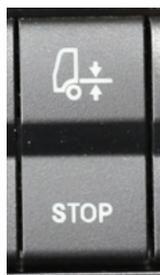
Das Fahrniveau kann auch durch Betätigen der oberen Taste des Schalters „Fahrniveau“ eingestellt werden. Mit der unteren Taste wird das Heben bzw. Senken des Fahrzeugs gestoppt.
