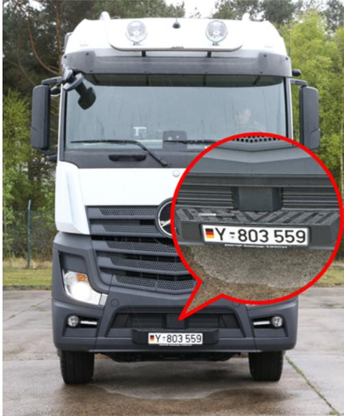
Der Active Brake Assist unterstützt den Fahrer, um die Gefahr eines Auffahrunfalls auf ein vorausfahrendes Fahrzeug oder ein stehendes Objekt im Fahrweg zu minimieren und die Folgen eines Auffahrunfalls zu reduzieren.
