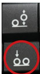
Durch Betätigen der unteren Taste für die Anfahrhilfe wird die Nachlaufachse entlastet (hochgezogen) und auf der Antriebsachse herrscht nun eine höhere Achslast. Dieses soll das Durchdrehen der Antriebsräder auf rutschiger Fahrbahn verhindern. Deaktiviert wird die Anfahrhilfe entweder direkt über den Schalter oder automatisch bei einer Fahrgeschwindigkeit größer 30 km/h.
