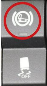
Durch Betätigen der Taste wird die Rollsperr aktiviert. Durch erneutes Betätigen wird die Rollsperr deaktiviert.
